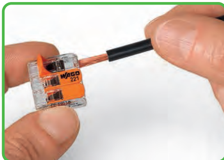
Zapojení vodiče: Otevřete upínací pružinu pomocí ovládací páčky a vložte vodič.
