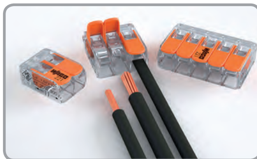
Dostupné ve dvou-, tří- a pětipólovém provedení. S řadou 221 můžete bezpečně a spolehlivě připojit jemně laněné vodiče od 0,14 do 4 mm 2 průřezu, stejně jako vodiče pevné s průřezem od 0,2 do 4 mm 2 .
